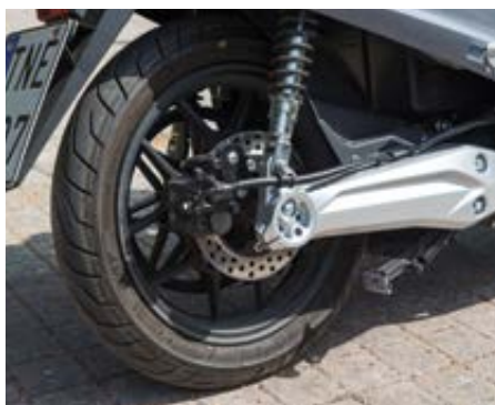
Το σύστημα φρεναρίσματος του scooter αποτελείται από διπίστονες δαγκάνες, δίσκους 220mm και 200mm, μπρος και πίσω αντίστοιχα, και σύστημα πέδησης CBS.
