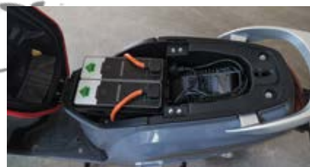
Ο ηλεκτροκινητήρας του e-Viball 125 έχει μέγιστη στιγμιαία ισχύς 3,2 kW με μέγιστη ροπή τα 44 Nm και παίρνει ενέργεια από δυο μπαταρίες 61,2 Volt στα 28,6Ah έκαστος.
