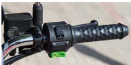
Ο αναβάτης μπορεί να επιλέξει ανάμεσα σε δυο «mode» οδήγησης, με το πρώτο να έχει στόχο την οικονομία ενέργειας και το δεύτερο να ελευθερώνει όλη τη δύναμη του κινητήρα.
